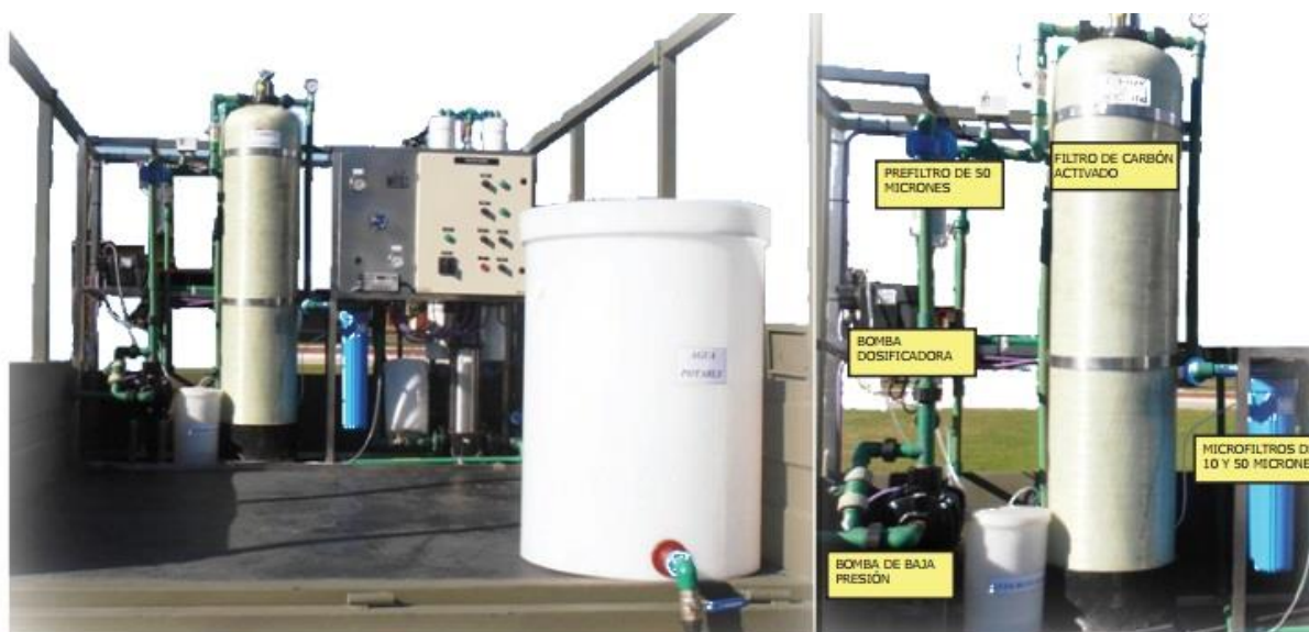
Foto 2. Equipo Potabilizador de Agua por Osmosis Inversa hasta 600 lts./hs sobre AR 1,5 ton
