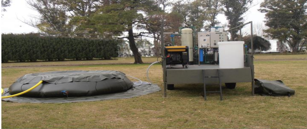
Foto 3. Equipo Potabilizador de Agua por Osmosis Inversa hasta 600 lts./hs sobre AR 1,5 ton con pileta 5000 lts de capacidad.
