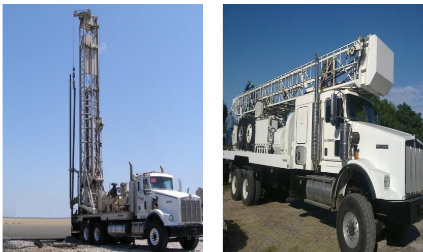
Foto 6. Equipo perforador GEFCO SS22 montado en camión Kenworth T 800.
