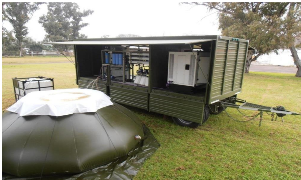
Foto 5. Equipo potabilizador de agua por ósmosis inversa Gran capacidad sobre AR 10 ton con pileta de 10000 lts de capacidad y Tanque de 10000 lts.
