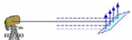
Menor reflejo con una placa inclinada.
