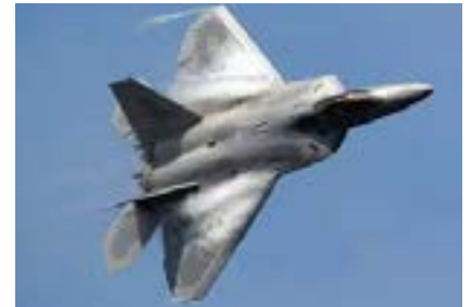
Algunos aviones furtivos de Estados Unidos (B-2 y F-22). La imagen nos muestra sus figuras geométricas y superficies preparadas, que logran dispersar las ondas de radar para disminuir su reflexión.
